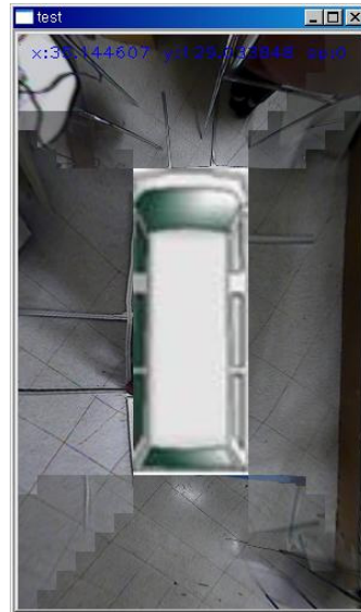
그림 12. 위치 정보를 가진 AVM 시스템의 결과 영상 Fig. 12 Result image of AVM System with location information
