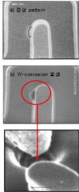
그림 5. W 부식의 주사전자현미경 사진 (a) 정상 패턴 (b) w 부식 발생 패턴 Fig. 5 SEM image of (a) normal pattern and (b) w corrosion pattern
