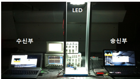
그림 6. 가시광통신 성능평가 및 연결 모습 Fig. 6 VLC system performance evaluation and link form
