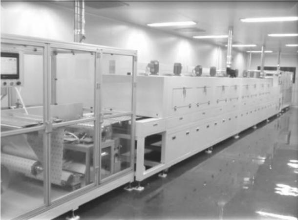
가식성 필름의 여러 제조 공정을 획기적으로 개선하여 일체화 한 장비로 포장필름 하부 자체에 연속적으로 코팅/건조/포장 공정을 일괄적으로 수행하며 생산성 극대화 및 위생문제를 해결했다.
