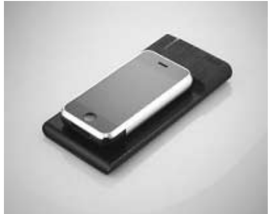
[그림 3] 비접촉전원방식의 휴대전화 충전기
