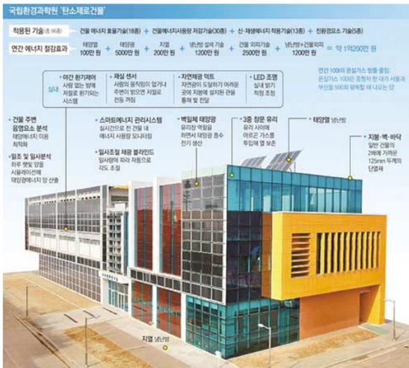
하는 방식으로 건물에 필요한 에너지의 60%를 조달한다. 나머지 필요 에너지 40%는 일반건물(60~80mm)보다 두꺼운 125mm의 슈퍼단열재를 이용해 에너지를 보존하는 방식으로 충당한다.
