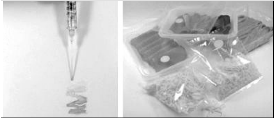
▲ VTT 기술연구소에서 개발한 산소감지 잉크와 이를 포장에 적용한 예
