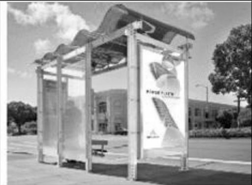
▲ 네덜란드의 Holst Center에서 개발한 인쇄유기조명 (왼쪽)과 미국 Konarka社에서 제조하여 버스정류장에 설치한 인쇄유기태양전지 (오른쪽)
