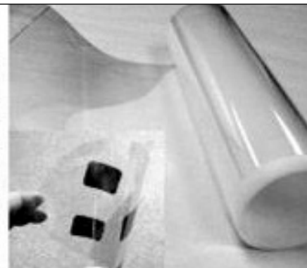
▲ 미국의 Vitex社에서 개발한 고분자/무기물 중첩구조로 형성된 유기소자의 가스차단용 박막 (왼쪽)과 이 기술을 이용하여 만든 인쇄유기소자용 보호필름 (오른쪽)
