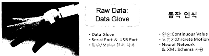
그림 4. Data Glove ® 를 이용한 동작 인식 원리
