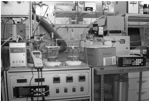
그림 1. 온습도 조절 장치로 감도변화를 측정하는 모습
