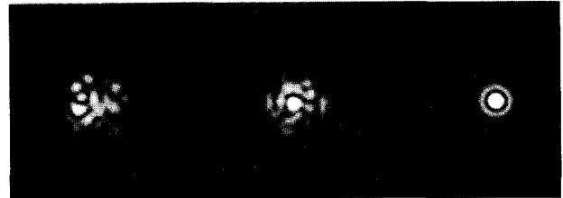
그림3. 京大신기술 망원경의 18매 분할경에 대한 위상맞춤의 효과. 분할경 포커싱과 위치맞춤만을 마친 상태(좌도)에서 위상을 맞춘 상태(우도)까지의 단일파장에서의 회절한계 image 변화. 실제로는 파장 차이에 의한 다양한 패턴의 겹침 때문에 smooth하게 확장된다. 또 미러의 분할수가 증가할수록 차이는 크게 된다.
