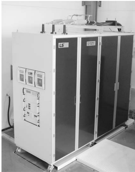
실증시험 중인 초전도 한류기와 시험 선로
