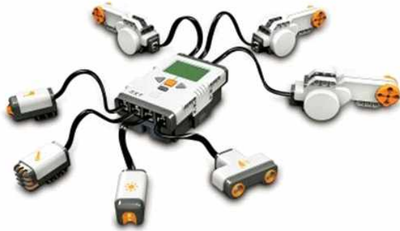
(그림 1) NXT 브릭과 연결된 3개의 모터와 4개의 센서들
