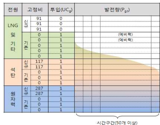
그림 4. 투입여부와 발전량의 개념적 관계 Fig. 4. Determining scheme of UC g & P g,t in the process of optimization
