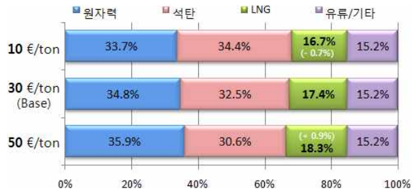
그림 9. CO 2 배출비용에 따른 최적전원구성 변화 Fig. 9. Optimal fuel-mix change according to CO 2 market price
