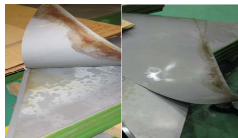
그림 6 철심의 과열 및 변색 Fig. 6 Core heating and discoloration
