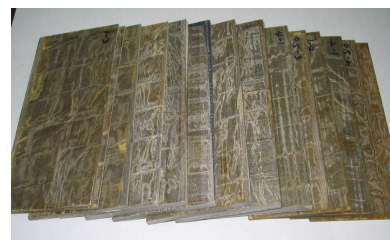
그림 6 발전기 권선 절연물 시편 Fig. 6 Specimens for winding insulation
