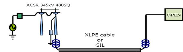
그림 3 345kV 혼합송전선로 모델링
