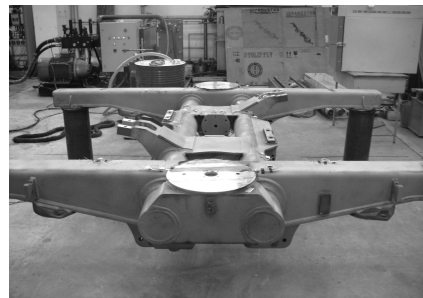
그림 4. 국내 차량제작사 위탁 대차 피로시험
