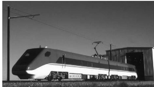
그림 7. 일본 RTRI 궤간가변차량 시험
