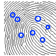
그림 6. 세선화 영상에서의 의사 특징점 발생 Fig. 6. Pseudo Feature Generation of Thinning Image
