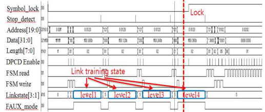
Fig. 11. Simulation result of FAUX forward training (source) 그림 11. 고속 보조 채널 정방향 트레이닝 모의실험 결과(source)
