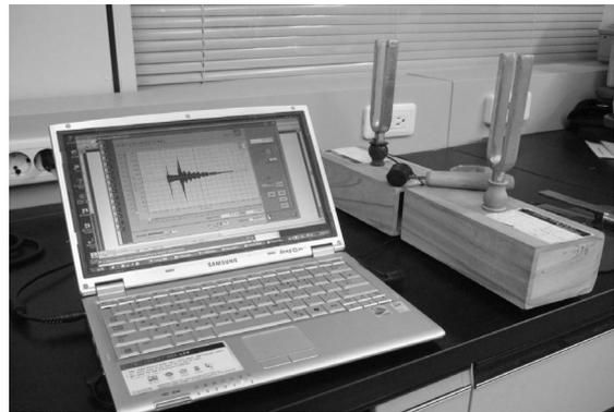
그림 2. 두 개의 소리굽쇠를 이용한 맥놀이 실험
