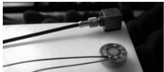
그림 6. 역학 커플러 위의 스피커와 진동센서 Fig. 6. Speaker and Vibration sensor on Coupler.
