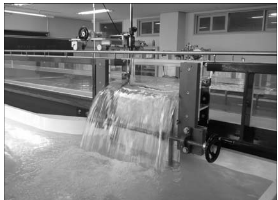
그림 2. 주수로에 설치된 횡월류 위어
