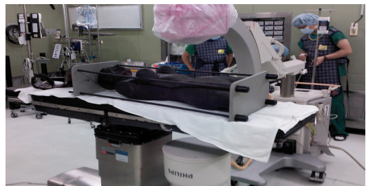
그림 2. 팬텀과 C-arm 장치 설치
