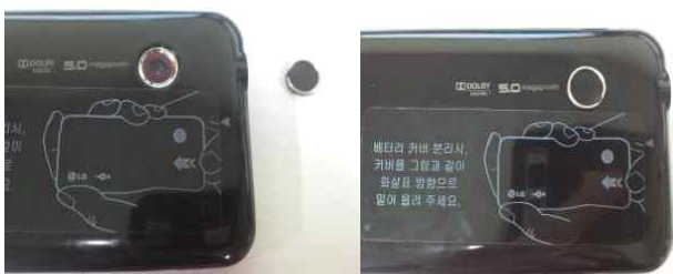
(그림 7) 적외선 필터(좌), 적외선 필터 장착 후(우)
