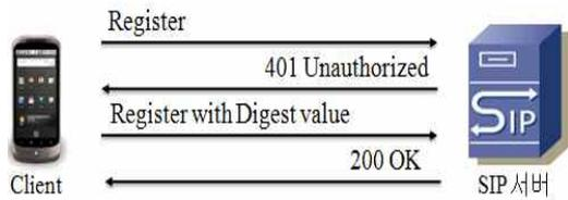
(그림 7) HTTP Digest 연산 시간 측정 방법
