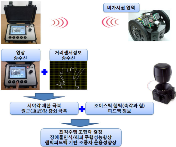
그림 7. 직관적 조향결정 성능향상 원격 조종기 개념도. Fig. 7. Conceptual remote control for enhancing the intuitive steering determination.
