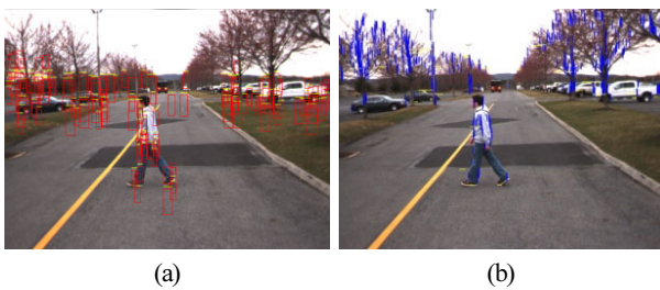
그림 5. (a) 색상차이법 적용전 에지 (b) 적용후의 에지. Fig. 5. Edge distribution before and after applying different color method: before (a) and after (b).
