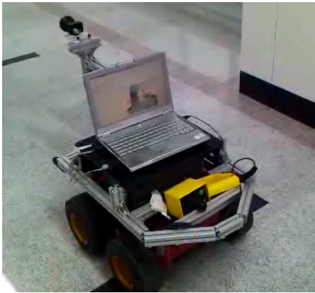
그림 7. 실험에 사용한 로봇 (MobileRobot's P3-AT). Fig. 7. A robot used in experiments (MobileRobot's P3-AT).
