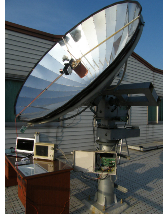
그림 10 양축 추적식 태양열 발전시스템 Fig. 10 Solar power generation system of two-axis tracking type
