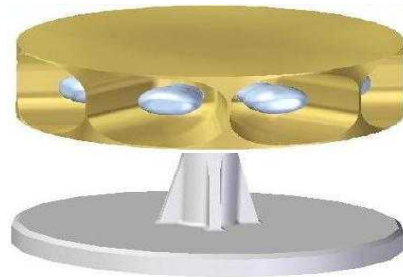
그림 5. 음압차에 의한 기적음 방향추정 장치 Fig 5. Equipment for direction estimation by the sound pressure difference
