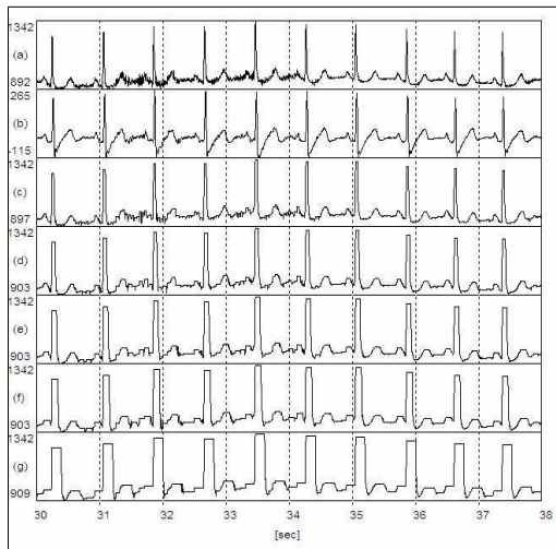
그림 3 MIT/BIH 101번에서 잡음 심전도와 BPF처리 및 본 방법에서 일정시간 tH 을 변경하며 적용한 비교 (a) 원 신호 (b) 1~30Hz BPF (c) t H = 22.2 ms (d) t H = 41.7 ms (e) t H = 63.9 ms (f) t H = 83.4 ms (g) t H = 138.9 ms Fig. 3 MIT/BIH results. (a) Row data (b) 1~30Hz BPF (c) t H = 22.2 ms (d) t H = 41.7 ms (e) t H = 63.9 ms (f) t H = 83.4 ms (g) t H = 138.9 ms
