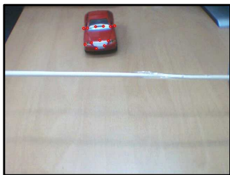
그림 13. Harris Corner Detector를 이용한 모형 자동차 특징 추출 Fig. 13 Harris Corner Detector feature extraction using a model car
