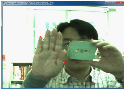
그림 6. L-K 특징 추적이 가림에 의한 오류 발생 Fig. 6 LK feature tracking errors due to the occlusion
