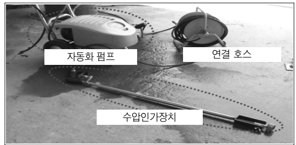
그림 7. 튜브형 강관 록볼트 시공을 위한 부가장비 구성
