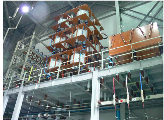
그림 3. 직접시험법을 적용한 고주파수 TRV 발생법 시험설비
