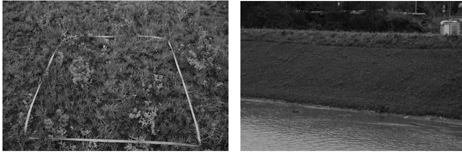
그림 5. 시공 1년 경과후의 식물생육상황(좌 : 방형구사진, 우 : 시공지 전경).
