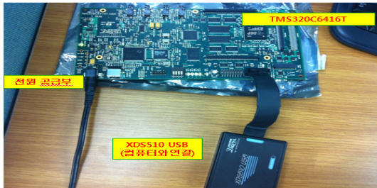
그림 11. TMS320C6416T DSP 구조 Fig. 11. Structure of TMS320C6416T DSP
