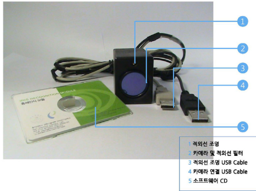
그림 2. 홍채영상 획득 / 인식 시스템 Fig. 2. A prototype of iris recognition system
