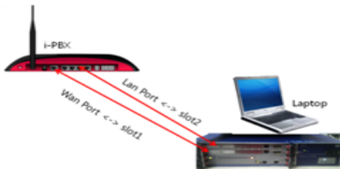
그림 13. 동시 호 측정 개념도 Fig. 13. The conceptual diagram of measuring the number of simultaneous telephone calls
