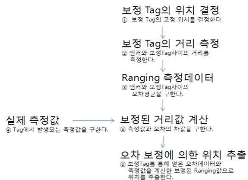
그림 6. 보정태그를 이용한 알고리즘 Fig. 6. Algorithm using Calibration Tag
