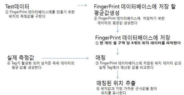
그림 4. 삼각측량법과 Fingerprint 방식을 결합한 알고리즘 흐름도 Fig. 4. Algorithm Flowchart for Integration of Trigonometry and Fingerprint Method
