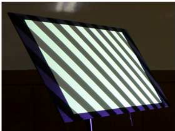
그림 7. 영상 투사 위치검출을 위한 바이너리코드 이미지 투사 모습. Fig. 7. Binary code image projection to capture the desired location of beam projection.
