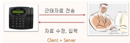
그림 2. 기존 근태관리시스템의 하드웨어 구성도 Fig. 2. The hardware structure of the recent diligence and indolence management system
