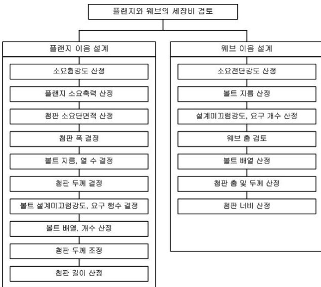
그림 2. 보 이음 마찰접합부 표준설계법
