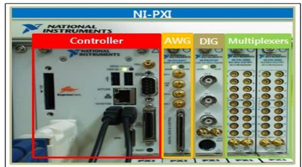
그림 4. 실험을 위한 DAQ 시스템
