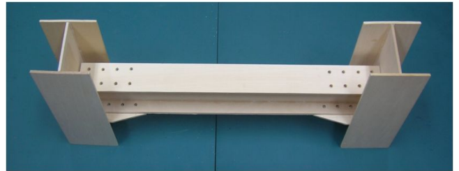
(b) 수평보 설치 및 하부 용접플레이트와 수평보의 고력볼트접합
