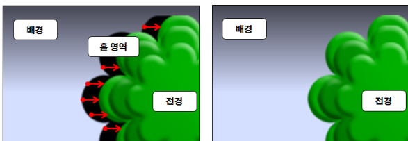
그림 5. 방향 보간 홀 채움 방법 Fig. 5. (a) Warped color image with hole region (b) Result of traditional directional interpolation method
