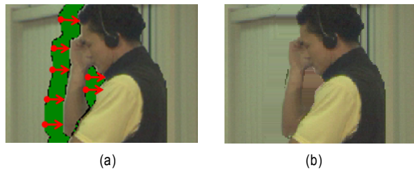
그림 6. (a) 홀을 갖는 워핑된 색상 영상 (b) 방향 보간 방법의 잘못된 홀 채움 Fig. 6. (a) Warped color image (b) Erroneous hole filling result
