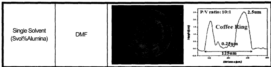
Fig. 1. 유기 잉크 시스템들의 용매 증발 후 분말 적층 모양.
