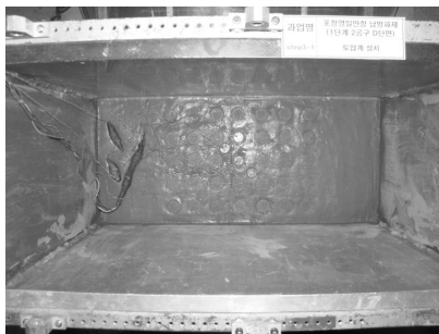
그림 4 점토층 보강 및 토압계 설치
