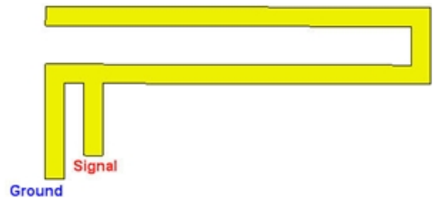
그림 3. IFA 구조 Fig. 3. Geometry of IFA.
