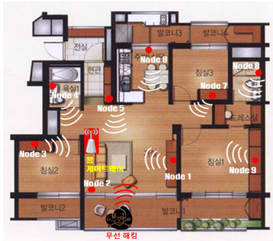
[그림 8] 스마트 홈에 실험을 위해 센서노드 배치 [Fig. 8] Smart home for experiments placed the sensor nodes
