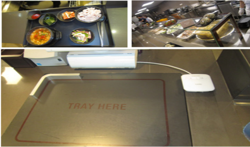
그림 3. RFID 칩이 내장된 식기와 자동 인식 시스템 Fig. 3 Tableware and automatic recognition system with RFID chips
